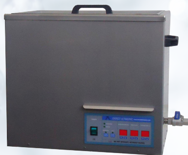
Ultraljudsvätt Autoclean 400. Påsfiltersystem, oljeseparator och agitering.
